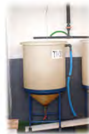
Figura 1.5b. Tanque cilindrocónico (Foto: Victoria Anguís)
